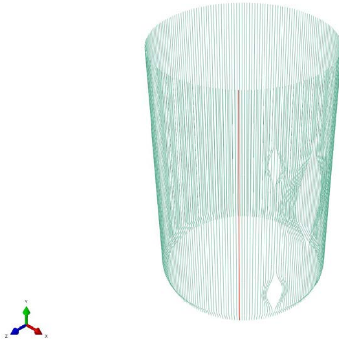
Figur 55 Illustration av placeringen av spännkabeln som förutsätts vara inaktiv (illustrerad med röd färg)
