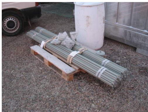
Figur 18. Bergbultar med dubbelt rostskydd med zink och epoxi med brickor och muttrar (Foto Bogdanoff 2010)
