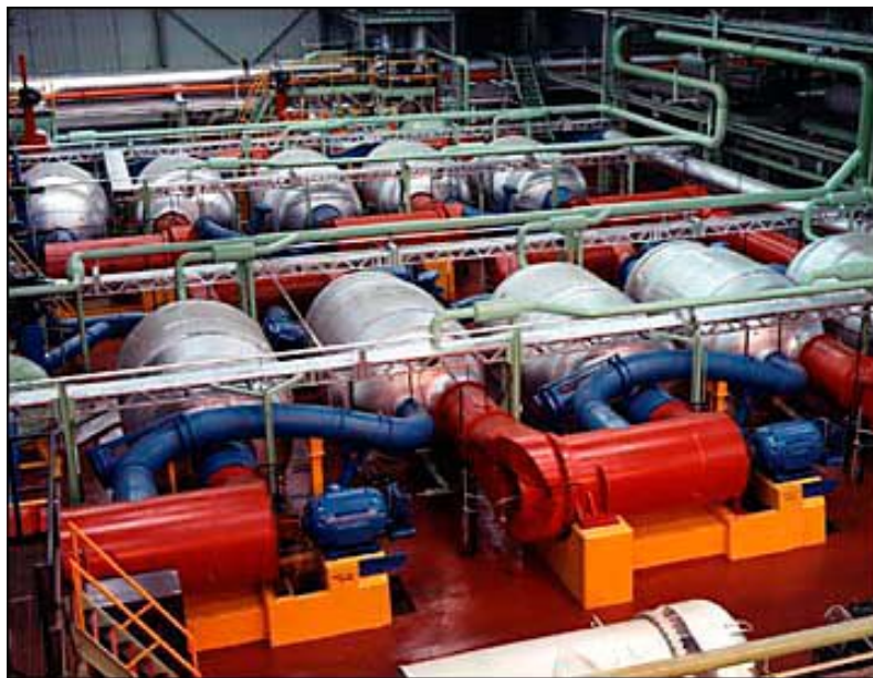
Figur 3. Gasseparationssteg för uranhexafluorid i symmetrisk kaskad.
