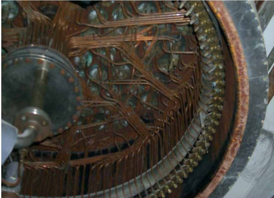
Figur 7. Bilden visar botten på inneslutningen av Kuhnkolonnen som användes för destilleringen till 99,75 % vid Rjukan. Lägg märke till de separata nipplarna för varje enskild kolonn. Kuhnkolonnen beskrivs närmare i texten.
