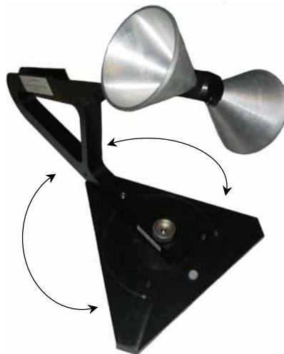
Figur 4 Mätantennen vreds till tre olika lägen för att mäta signaler från alla riktningar
