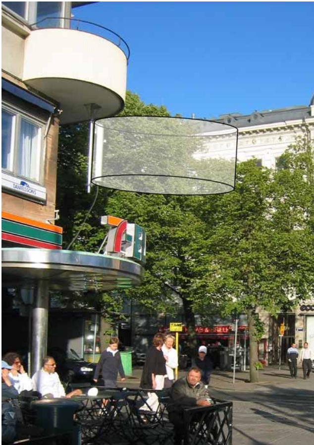
Figur 16 Basstationsantenn monterad under en balkong. För 3G-basstationer är det först när man befinner sig inom ett område som kan beskrivas med en tre meter stor cylinder (i samma höjd som antennen) som referensvärdet kan överskridas. Bakom, ovanför och under antennen är exponeringen mycket låg.
