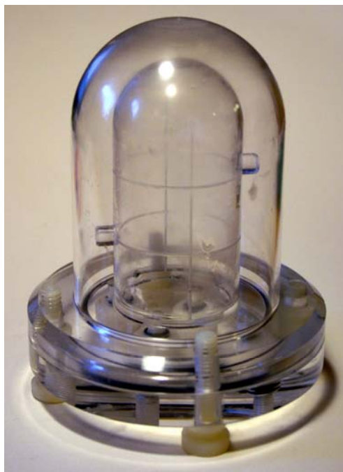
Figur 3 Hjärtfantomet där inre kaviteten fylls med vatten utan aktivitet och yttre fylls med aktivitet. På piggarna placeras defekterna.
