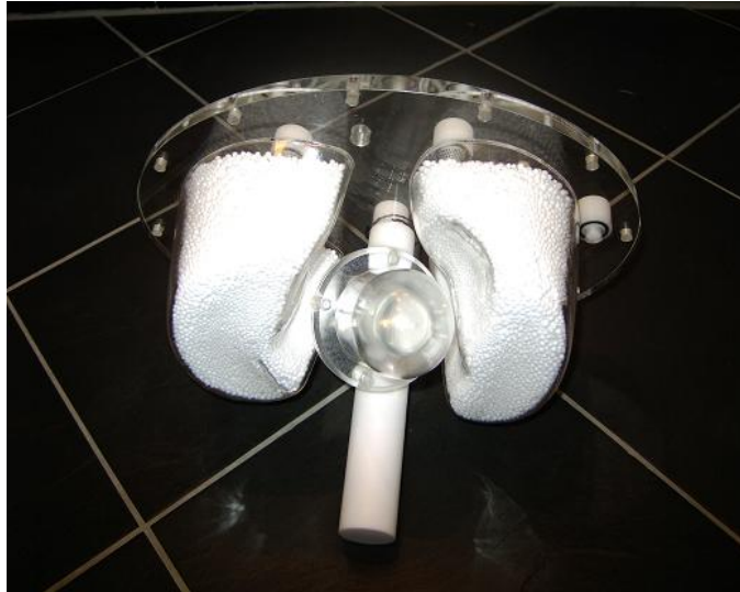
Figur 2 Thoraxfantomet med lungor, ryggrad och hjärtfantomet i sin upphängningsanordning.
