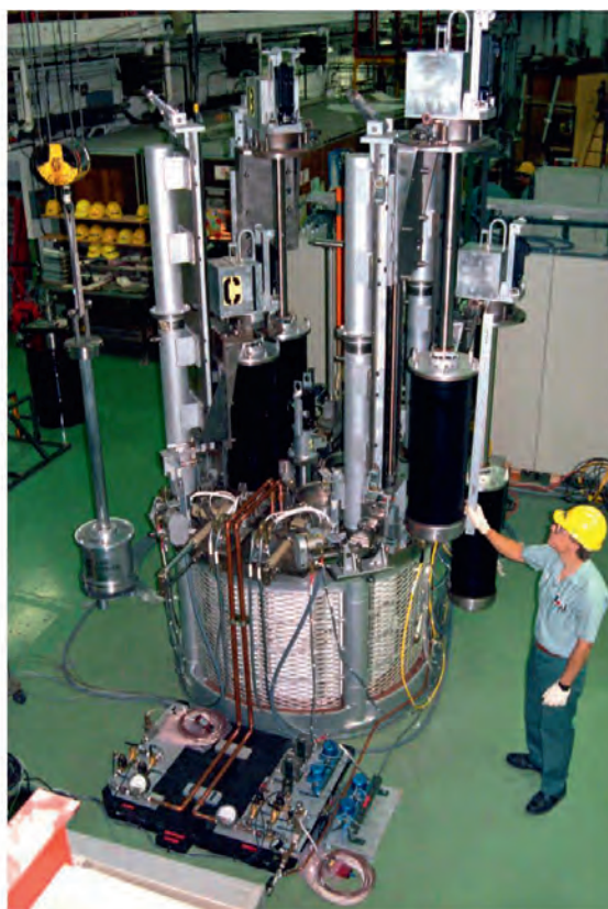
Figur 1. Den processcell som används vid elektrokemisk upparbetning. Publicerat i enlighet med Förenta Staternas regler för bilder skapade inom statlig verksamhet.
