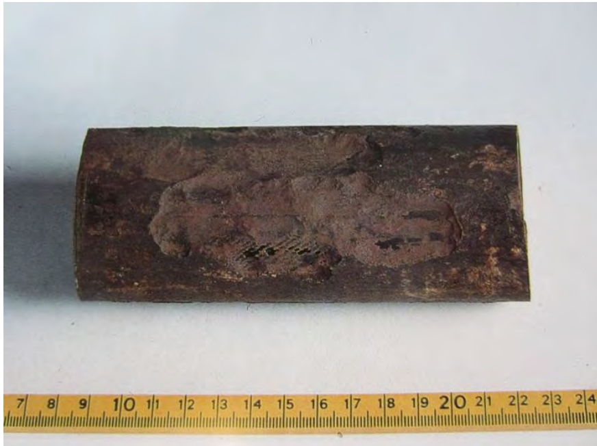
Figur 5. Exempel på utseende hos angrepp genom LSK på ett olegerat stål. Notera den lokala utbredningen. Källa [23].
