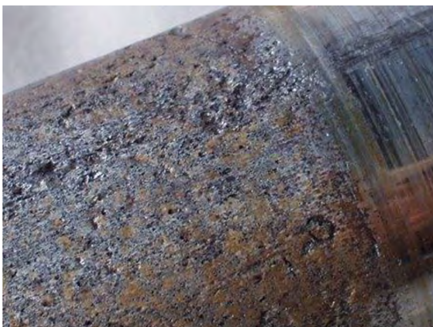
Figur 4. Exempel på LSK på rostfri propelleraxel som utvecklats inom 8 timmar. Jämför med opåverkat material i bildens övre högra hörn. Källa [21].
