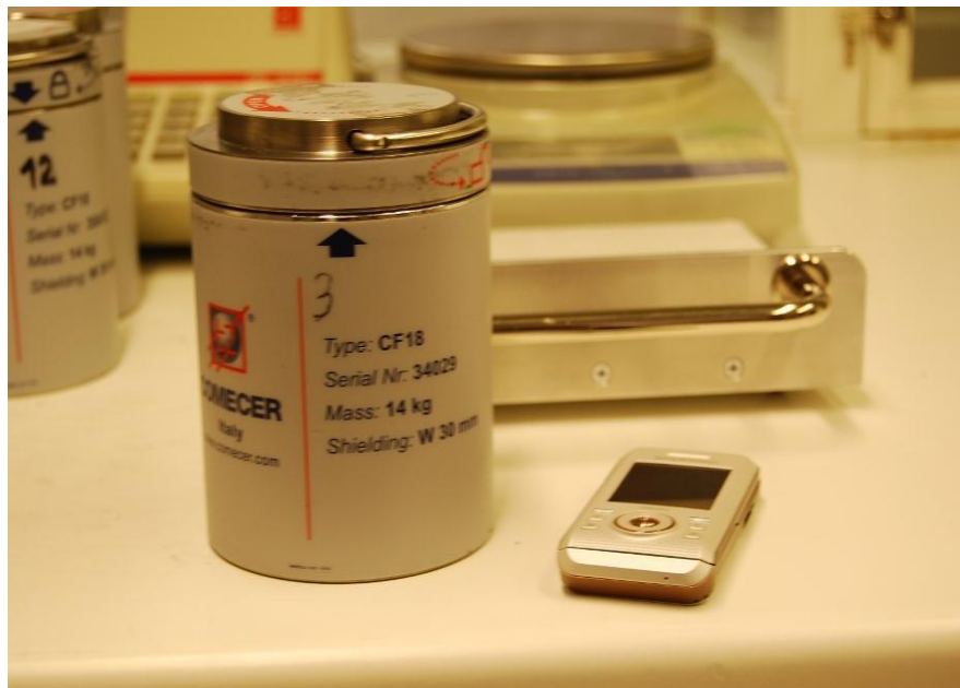
Bild 1: Innerbehållare tillverkad av wolfram för transport av F-18. Höjd ca 20 cm och en diameter på drygt 10 cm. Vikt ca 14 kg. Som storleksjämförelse ligger en mobiltelefon bredvid behållaren.
