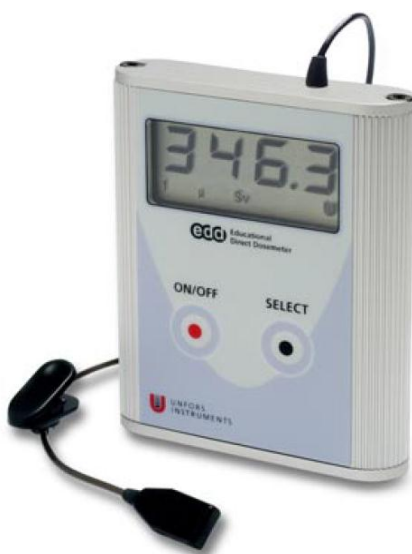
Figur 1: Unfors EDD-30. Sensorns mått är 22 x 11 x 6 mm.
