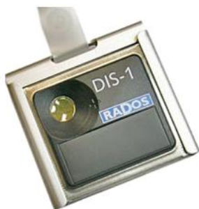
Figur 5: Mirion DIS-1. Dosimeterns mått (exklusive hållaren) är 44 x 41 x 12 mm.
