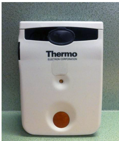
Figur 4: Thermo Scientific EPD. Dosimeterns mått är 85 x 63 x 19 mm.
