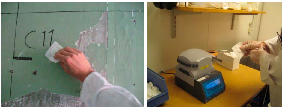
Figur 5-1. Provtagning och analysutrustning för strykprov i en lokal.
