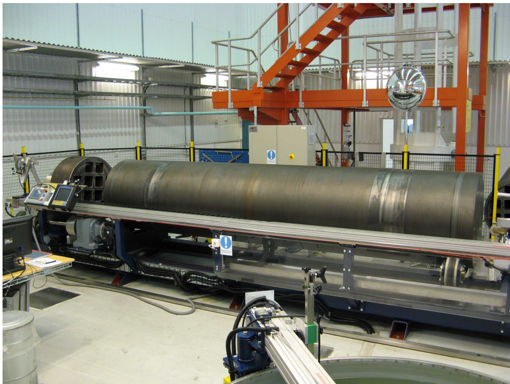
Figur 4-2. Rotator för provning av kopparrör och segjärnsinsats.
