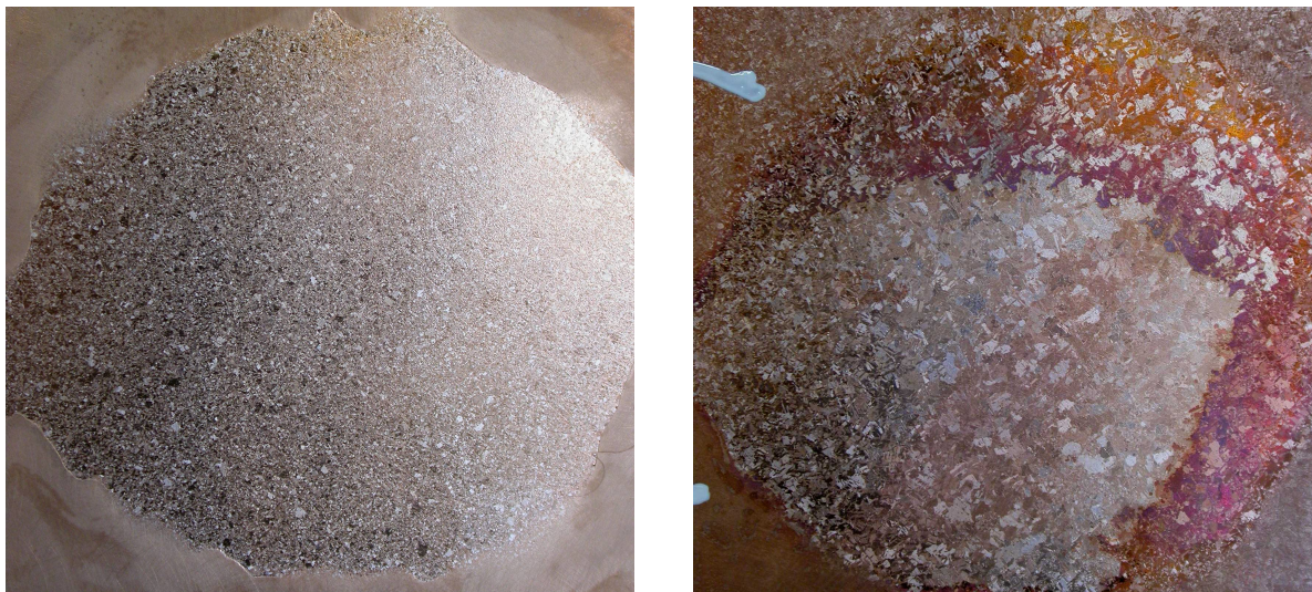
Figur 7-8. Etsade områden från rör T47. Till vänster visas ett område med låg ljuddämpning som har en medelkornstorlek på 60\ \mu\text{m} (största korn 170\ \mu\text{m} ) medan till det höger visas ett område med hög ljuddämpning och en medelkornstorlek 172\ \mu\text{m} (största korn 1\ 070\ \mu\text{m} ).
