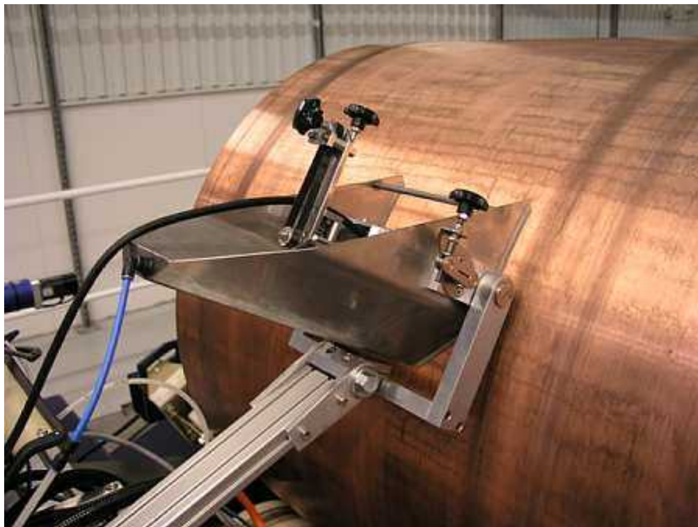
Figur 4-4. Immersionstub för provning av kopparrör och segjärnsinsats.
