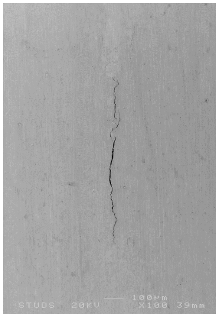
Figur 39 Översikt av ytbrytande spricka från SEM.
