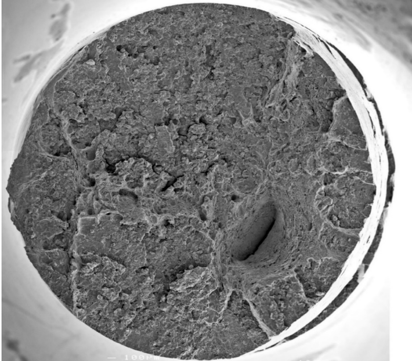
Figur 27 Fraktografi provstav 1. Översiktsbild i SEM av brottyta.
