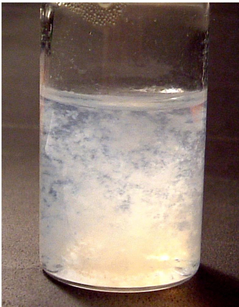
Figur 9. Fotografi som visar den amorfa fällning som erhöles när borsyrelösning, som fått reagera med zink vid 100°C, pH-justerats med fosfat och sedan avkylts till rumstemperatur
