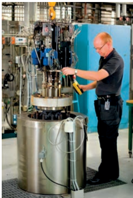
Figur 23 Vänster: Laddning av prover i en autoklav. Höger: Exempel på en uppsättning spricktillväxtprover innan exponering i autoklav.
