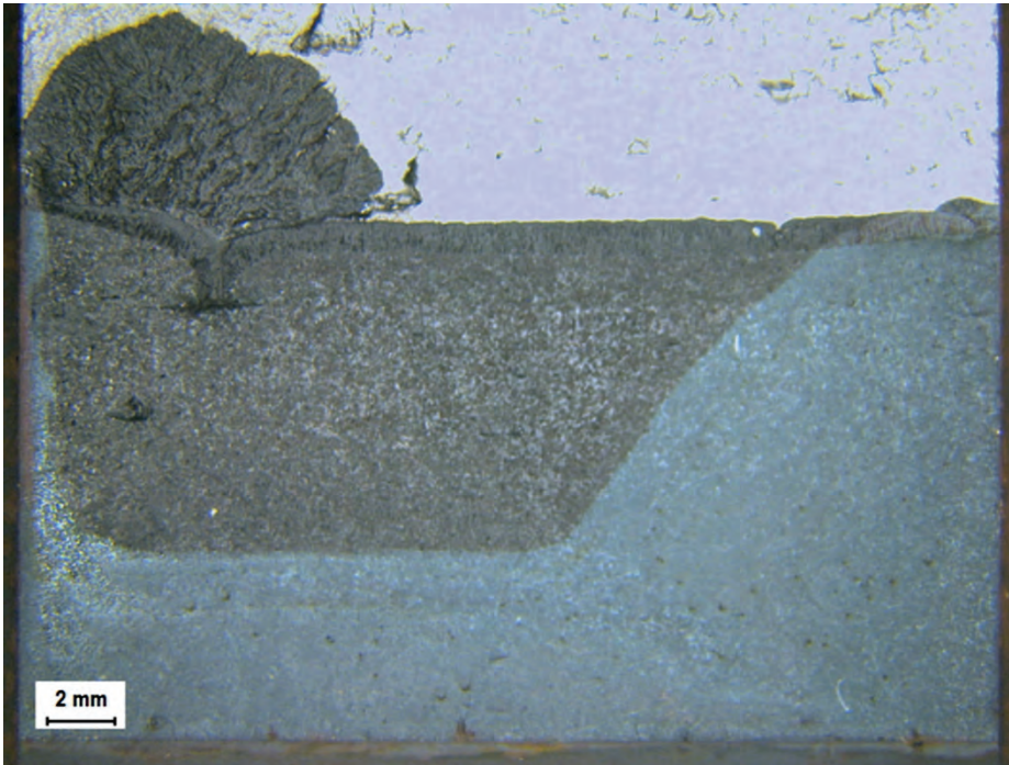
Figur H74: Uppmätning av sprickfronter på CT 12 för förutmatning i luft (a), förutmatning i miljö (b) och spricktillväxt vid provning (c). Mätningen utgår från den raka startnotchen som 0-position
