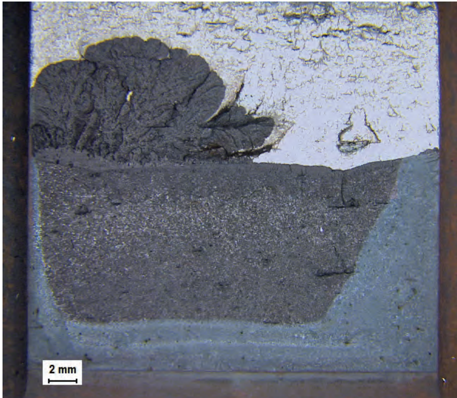
Figur H70: Uppmätning av sprickfronter på CT 10 för förutmattnig i luft (a), förutmattnig i miljö (b) och spricktillväxt vid provning (c). Mätningen utgår från den raka startnotchen som 0-position.
