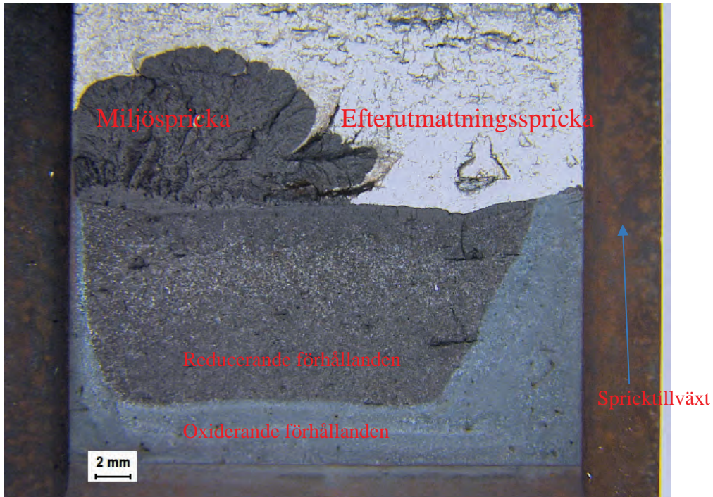
Figur 10: Översikt över brottytan på CT 10, autoklavposition 6 ( K = 60 \text{ MPa}\sqrt{\text{m}} , R = 1 ).
