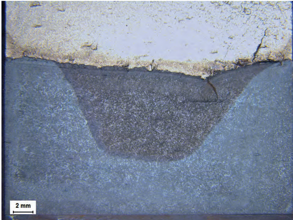
Figur H65: Översikt över brottytan på CT 8, autoklavposition 8 ( K = 60 \text{ MPa}\sqrt{\text{m}} , R = 0,7 ).
