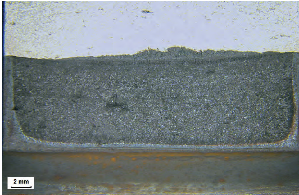
Figur H55: Översikt över brottytan på CT 3, autoklavposition 7 ( K = 50 \text{ MPa}\sqrt{\text{m}} , R = 1 ).
