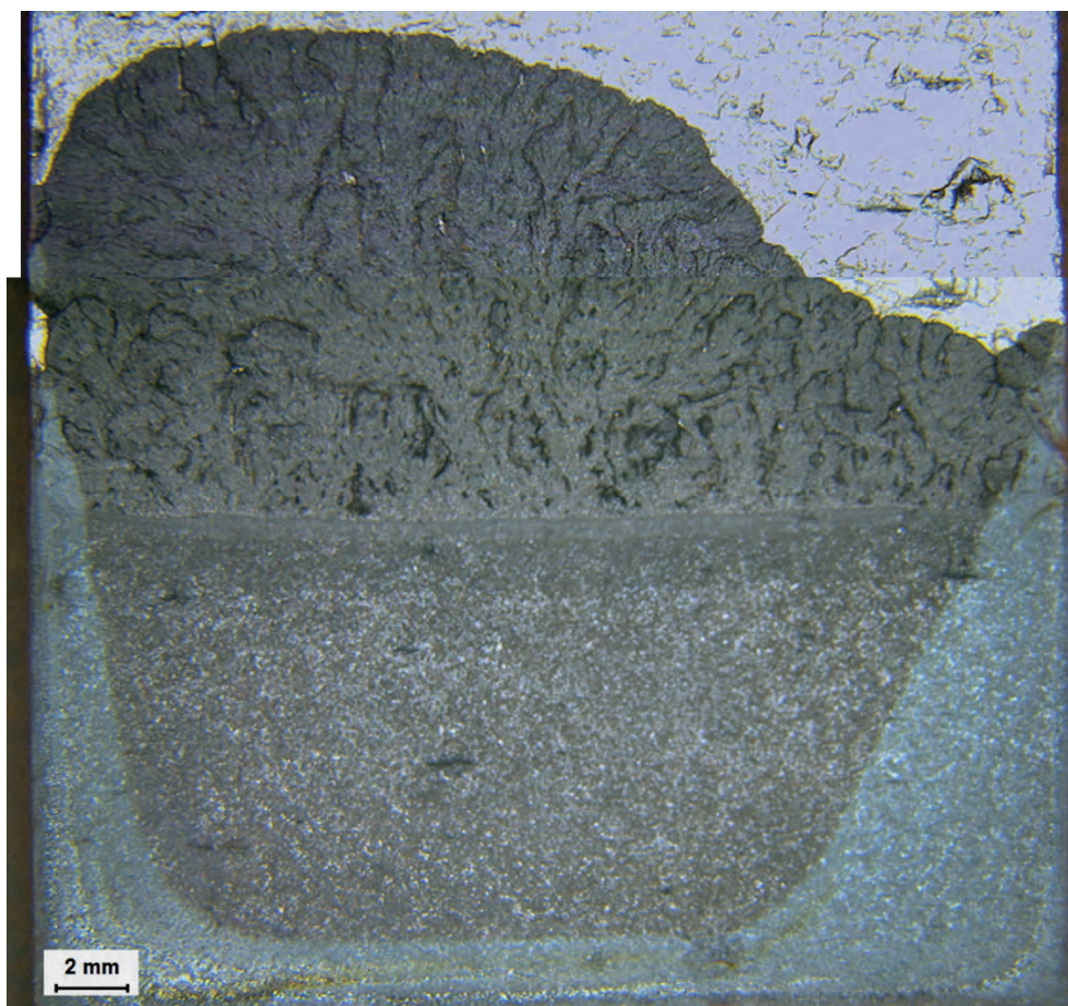
Figur H77: Översikt över brottytan på CT 15, autoklavposition 4 ( K = 50 \text{ MPa}\sqrt{\text{m}} , R = 0,7 ).
