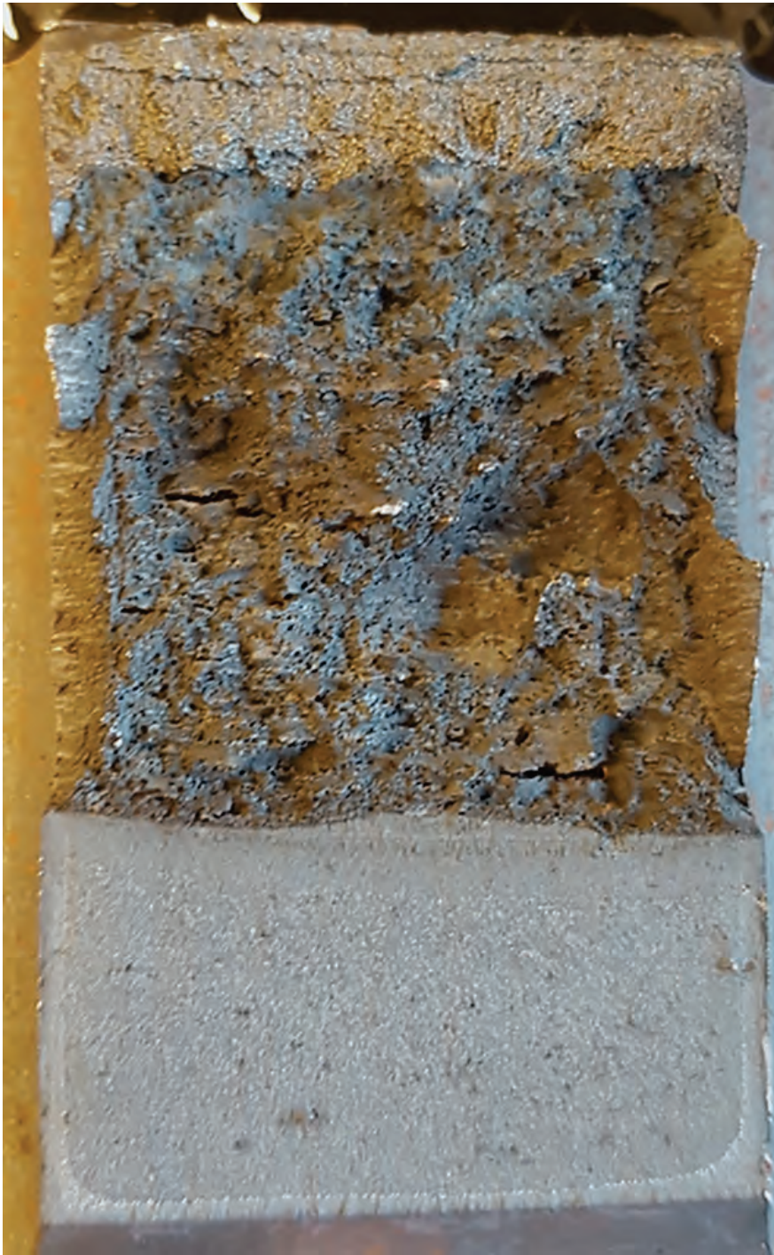
Figur H59: Översikt över brottytan på CT 5, autoklavposidon 4 ( K = 50 \text{ MPa}\sqrt{\text{m}} , R = 0,7 ).
