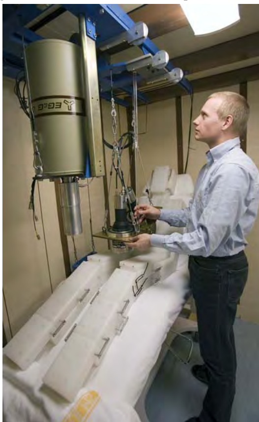
Helkroppsmätning av ^{137}\text{Cs} vid SSI. Mätpersonen (i det här fallet ett så kallat fantom) halvsitter i en vilstol under mätningen som tar ca 30 minuter.
