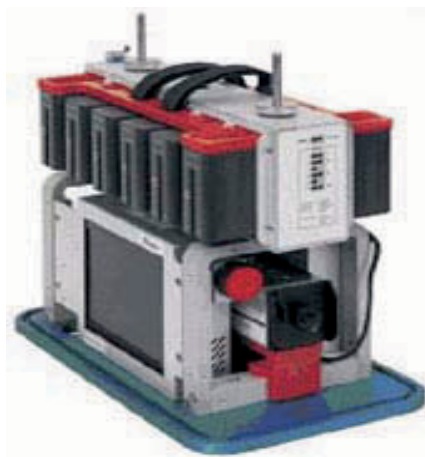
Figur 7.7. ALIP-systemet med dess bildskärm till vänster och batteripaket högst upp.
