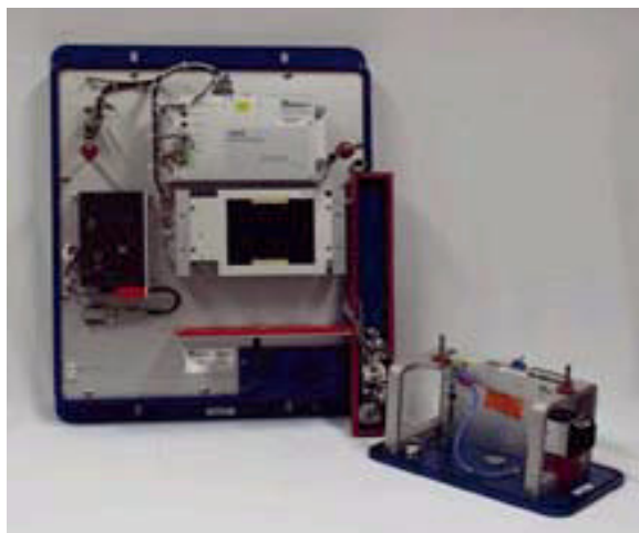
Figur 7.9. Ett DSOS-system med höljen till kameran (höger) och utläsningseenheten (vänster) avtagna.
