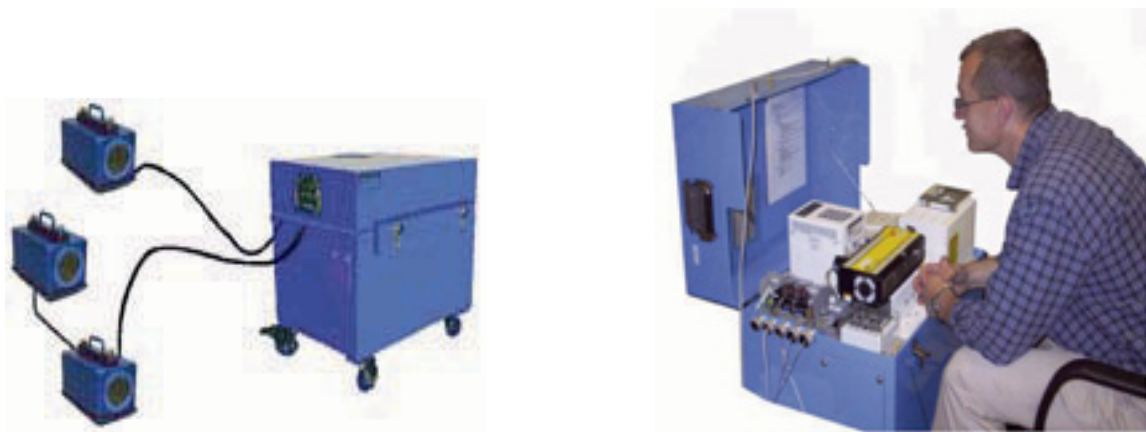
Figur 7.6. SDIS-systemet med 3 DCM14-kameror anslutna till vänster och serverutrustningen till höger.
