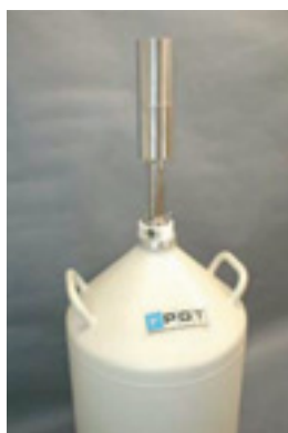
Figur 3.12. En typisk germaniumdetektor med sitt termoskär.
