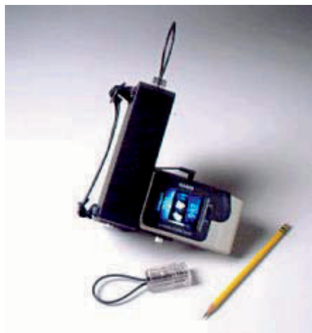
Figur 7.3. Det s.k. COBRA III Imaging System. Sigillet visas längst ned i figuren och ovanför detta avläsningsutrustningen. Från Canberra Inc.
