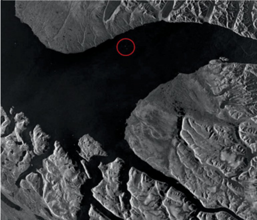
Figur 7.11. SAR-bild från den Kanadensiska satelliten RADARSAT-1 av is (mörkt) och landmassor. Inringat är en grupp studenter i en expedition från ett isforskningsfartyg. Från [139].
