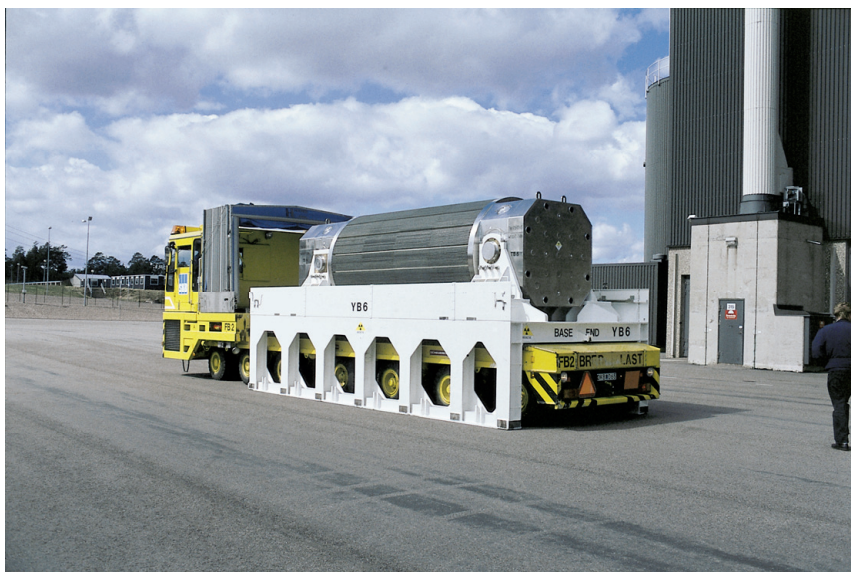
Figur 4-2. Terminalfordon med lastbärare och transportbehållare för använt bränsle
