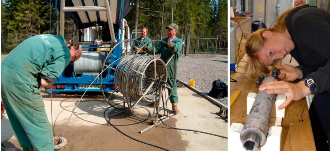
Figur B3-9. Bergspänningsmätningar i Forsmark. Till vänster sänkning av borrhålsutrustning för hydraulisk spräckning, till höger studium av friborrad borrhärna från överborrningsmätning.
