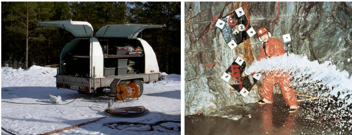
Figur B3-13. Till vänster Posivas utrustning för differensflödesloggning. Till höger borrhål under hydrauliskt övertryck i Äspölaboratoriet.
