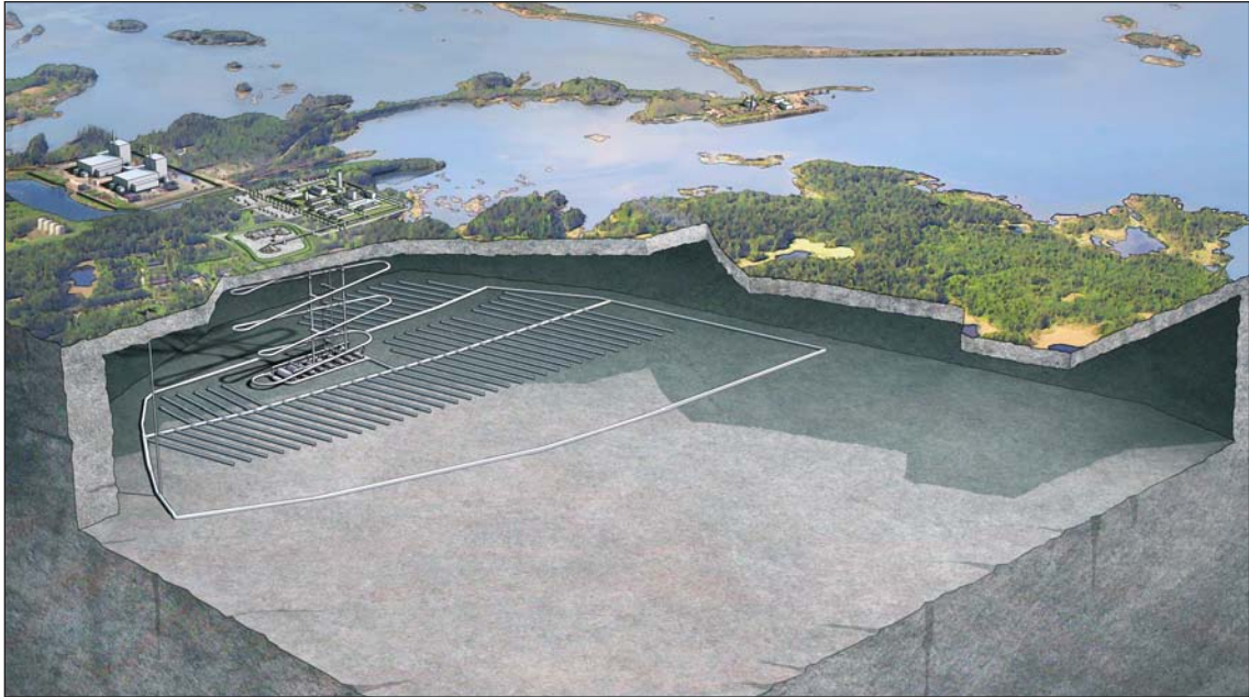
Figur 4-10. Slutförvarsanläggningens förvarsområde består av flera deponeringsområden och byggs ut i etapper. Figuren illustrerar utbyggd stamtunnel för ett nytt deponeringsområde inför uppförandet av deponeringstunnlar inom detta område.
