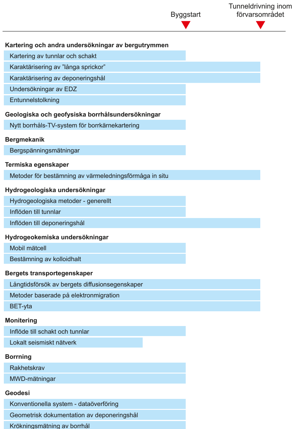
Figur 7-2. Översiktlig tidsplan för utveckling av undersökningsmetoder och instrument. Insatserna styrs så att utvecklingen är klar i god tid före byggstart respektive tunneldrivning inom förvarsområdet.
