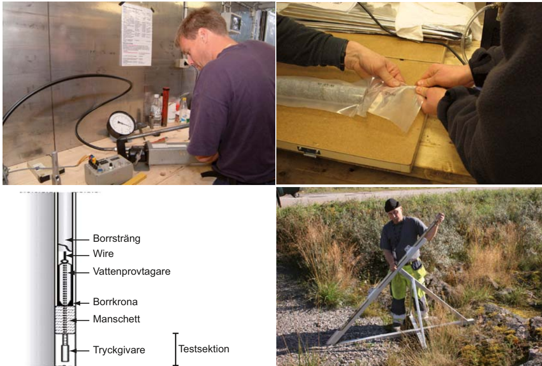
Figur B3-4. Ovan till vänster biaxialtestning av överborrningskärna vid bergspänningsmätning, ovan till höger förpackning av utsågat borrhållsprov för sändning till laboratorium. Nedan till vänster schematisk skiss av wireline-sond för hydraultest/vattenprovtagning under borrning, nedan till höger Flexit Smart Tool-sond avsedd för krökningsmätning av borrhål.
