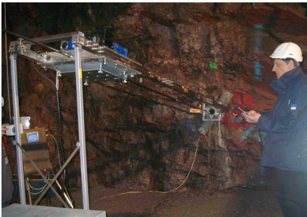
Figur B3-8. Införingsutrustning avsedd för t ex borrhålsgeofysisk utrustning i horisontella, subhorisontella och uppåtriktade underjordsborrhål.
