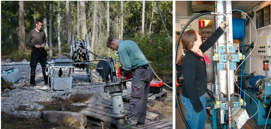
Figur B3-12. Bestämning av hydrauliska parametrar i ytborrhål med olika metoder. Till vänster pumptest i hammarborrhål, till höger injektionstester i kärnborrhål.
