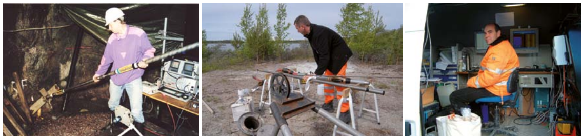
Figur B3-5. Geofysiska borrhållsundersökningar. Från vänster 1) BIPS-loggning i underjordshål, 2) konventionell geofysisk borrhållsloggning i ytborrhål samt 3) interiör från mätbuss för geofysisk loggning.
