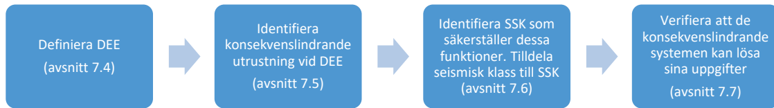
Figur 7.2 – Arbetsprocess för seismisk säkerhetsverifiering vid DEE.
