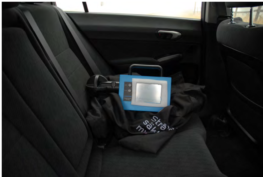
Figur 2. Magnetfältsmätning på vänster passagerarplats bak.
