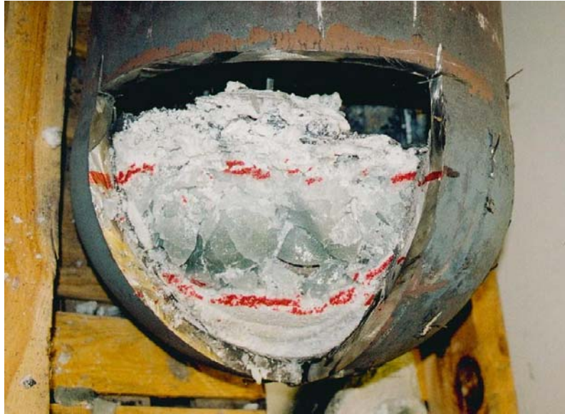
Figur 2.4.3: Genomskäring av tryckkärl i EC-FOREVER-5 test.
