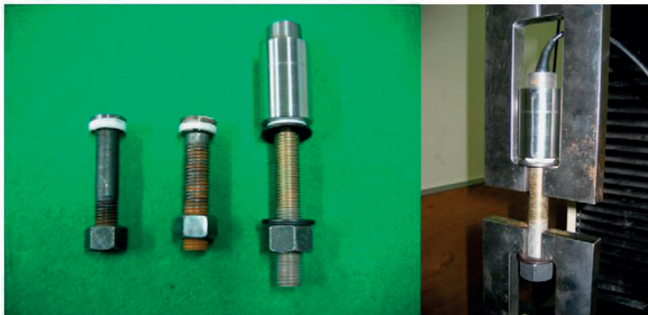
Figur 4.6 – Provxemplar för dragprov och mätning av TOF [17].
