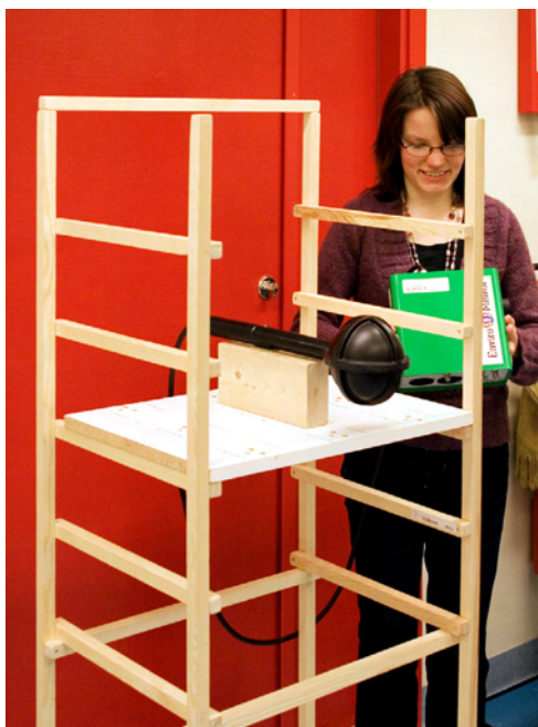
Figur 7. Mätantenn monterad på trästativ.
