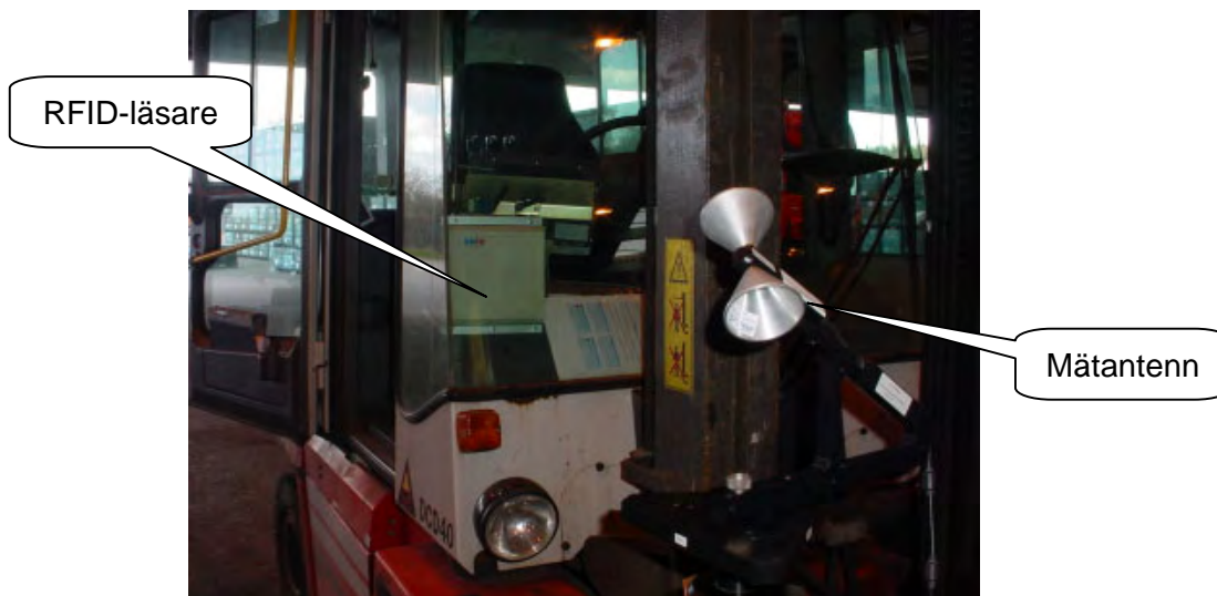
Figur 10. Mätuppställning med RFID-läsare och mätantenn.
