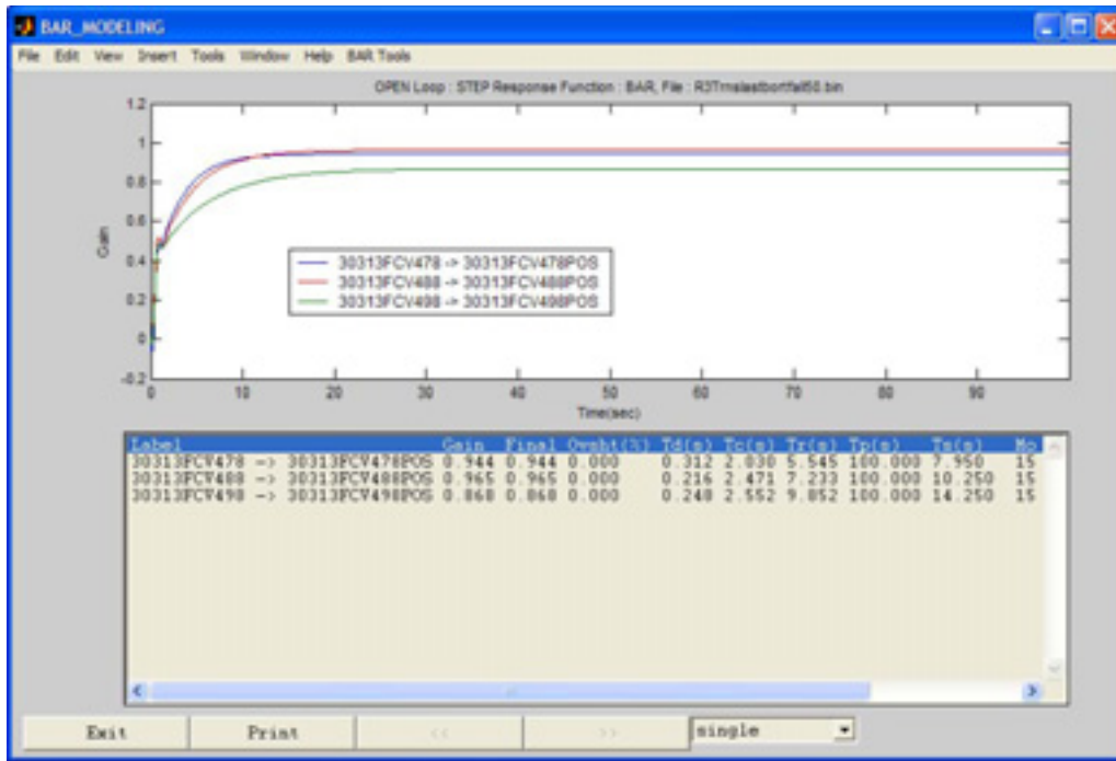
Figur6.3 Stegsvartest med de identifierade modellerna av regulatorns matarvattenventiler. Förstärkningarna är 0.94 för ÅG-1, 0.97 för ÅG-2 och 0.87 ÅG-3. Tidskonstanterna är 2.0 s för ÅG-1, 2.5 s för ÅG-2 och 2.6 s för ÅG-3.
