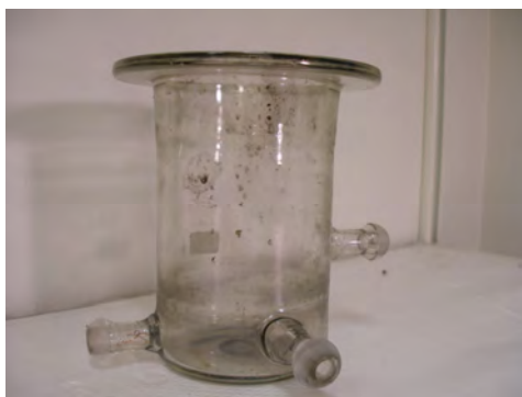
Figur 4.9: En bild av reaktionskärlet med betydande mängd svarta fläckar av deponerat rutenium.
